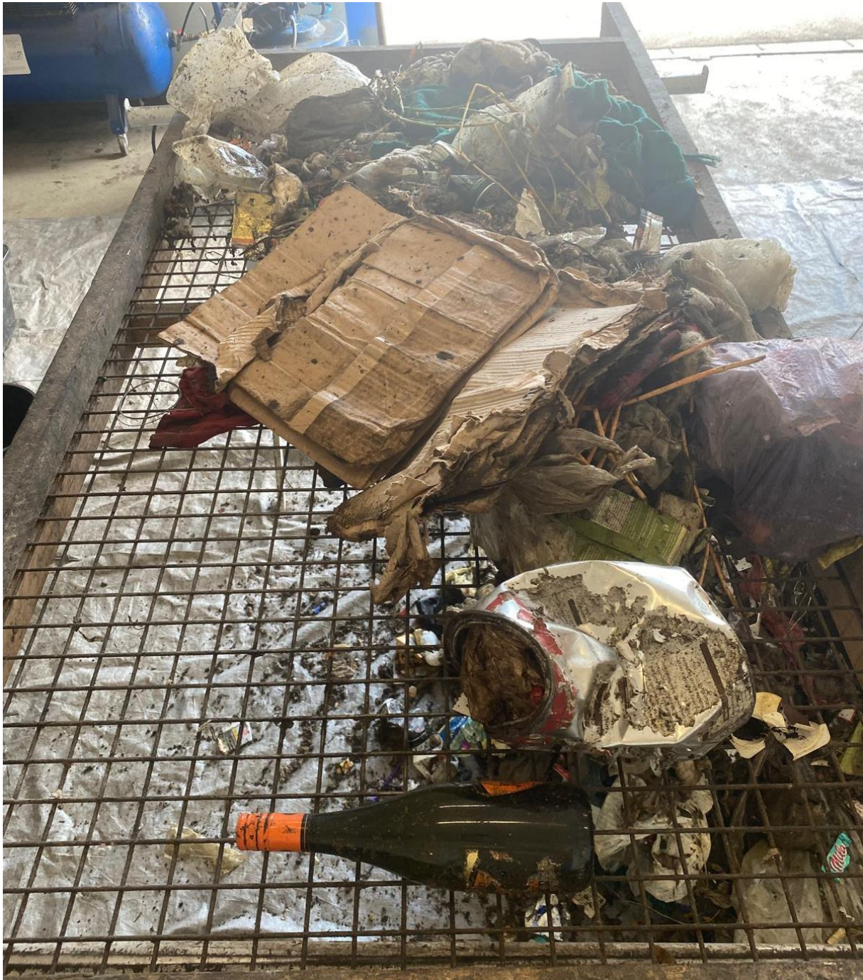
Obr. 4: Sítování odpadu a třídění (oka 40 mm)
